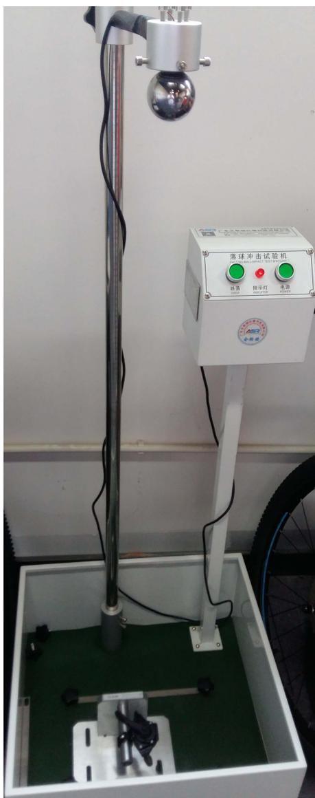
图 1 指拨操作杆抗冲击强度测试图
