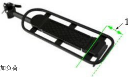
图 E. 2 横梁式行李架垂直静负荷最不利的施力点示意图
